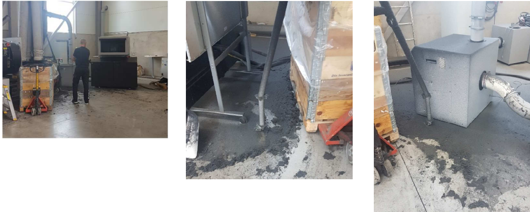
Fig 23. Resultat från malning av National Högsäters kantklipp hos Rapid Granulator. Dammbildning kräver speciellt hantering och bättre tätning av utrustningen
