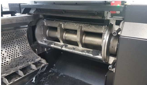
Fig 7. Rotor med knivblad i kvarn samt sikt (till vänster i bild)
