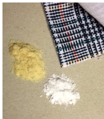
Fig 27. Rutigt mönster som tryckts på polyestertextil och resulterande monomer utan (till vänster) och med (till höger) behandling av aktivt kol.
