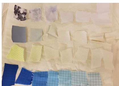
Fig 32. Avfärgning vid 150°C från 0-30 minuter
