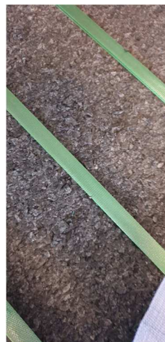
Fig 25. Närbild på kvarnat och kompakterat kantklipp.
