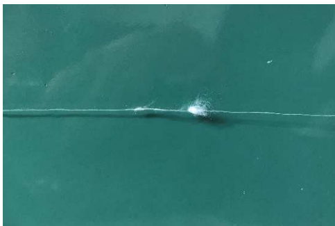
Fig 48. Defekt i tvistat polyestergarn för stickning.
