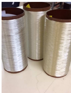
Fig 20. Bobbiner med smältspunna multifilament
