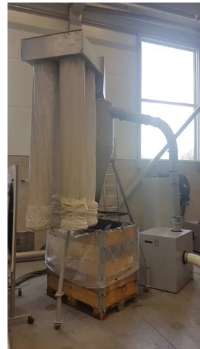
Fig 6. Uppsamlingsystem av kvarnat material.
