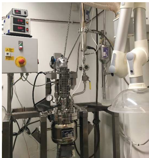
Fig 19. 5 liters reaktor för polymerisering. Kondensorenheten är de höga rören till höger i figuren.
