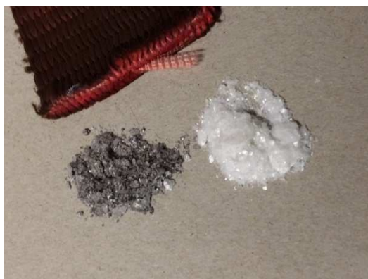
Fig 26. Rött spännband och resulterande monomer utan (till vänster) och med (till höger) behandling av aktivt kol.
