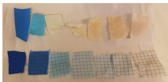
Fig 33. Avfärgning vid 170°C från 0-30 minuter.
