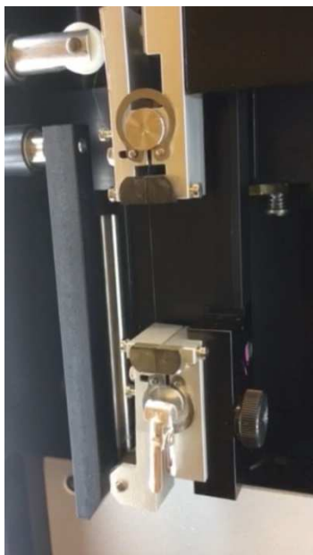
Fig 46 Vibrodyn för mekanisk testning av multifilament med filamentet inspänt
