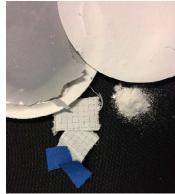
Fig 35. Avfärgat och depolymeriserat prov av sjukhustextil.
